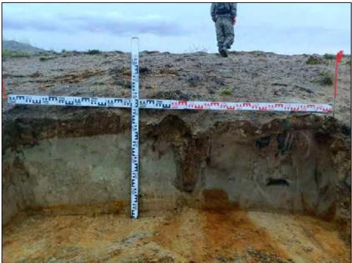
Рисунок 78. «Корректировка технического проекта ш.12393.09П «Сухоройный карьер песка на нефтяном месторождении им. Р. Трбса». Зачистка №9. Стратиграфический профиль южной стенки. Вид с С.
