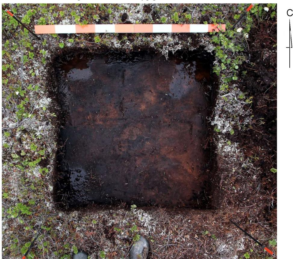
Рис. 25. Межпромысловый нефтепровод «ЦПС-ХТТ» Ардалинского нефтегазового промысла. Площадка подогревателя нефти в районе 42 км нефтепровода. Вид на поверхность раскопанного шурфа № 2 сверху. Вскрыт мерзлый торф
