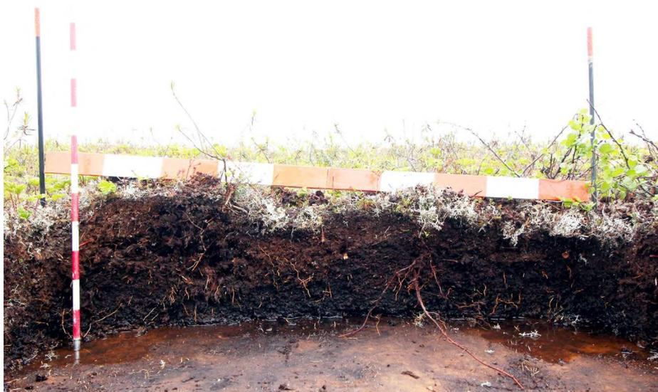
Рис. 26. Межпромысловый нефтепровод «ЦПС-ХТТ» Ардалинского нефтегазового промысла. Площадка подогревателя нефти в районе 42 км нефтепровода. Вид на северную стенку шурфа № 2 с юга. Вскрыт мерзлый торф
