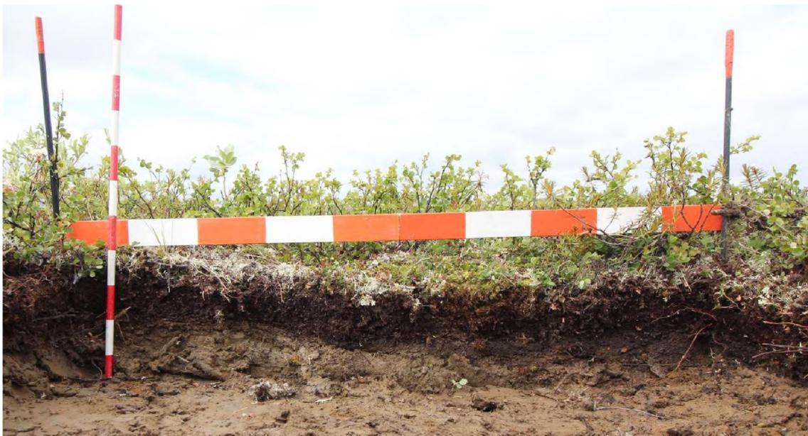
Рис. 20. Межпромысловый нефтепровод «ЦПС-ХТТ» Ардалинского нефтегазового промысла. Площадка подогревателя нефти в районе 42 км нефтепровода. Вид на западную стенку шурфа № 1 с востока. Вскрыт суглинок – пльвун, стенка шурфа оплывает
