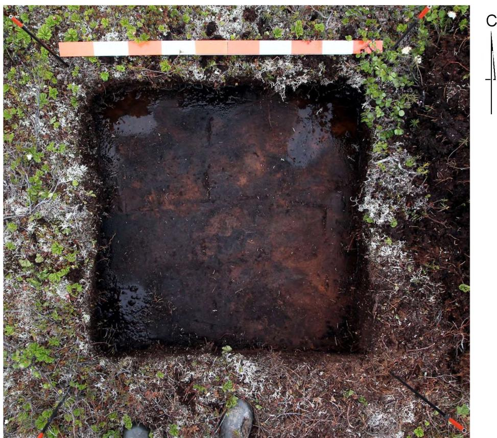
Рис. 25. Межпромысловый нефтепровод «ЦПС-ХТТ» Ардалинского нефтегазового промысла. Площадка подогревателя нефти в районе 42 км нефтепровода. Вид на поверхность раскопанного шурфа № 2 сверху. Вскрыт мерзлый торф
