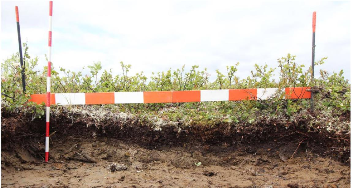
Рис. 20. Межпромысловый нефтепровод «ЦПС-ХТТ» Ардалинского нефтегазового промысла. Площадка подогревателя нефти в районе 42 км нефтепровода. Вид на западную стенку шурфа № 1 с востока. Вскрыт суглинок – пльвун, стенка шурфа оплывает
