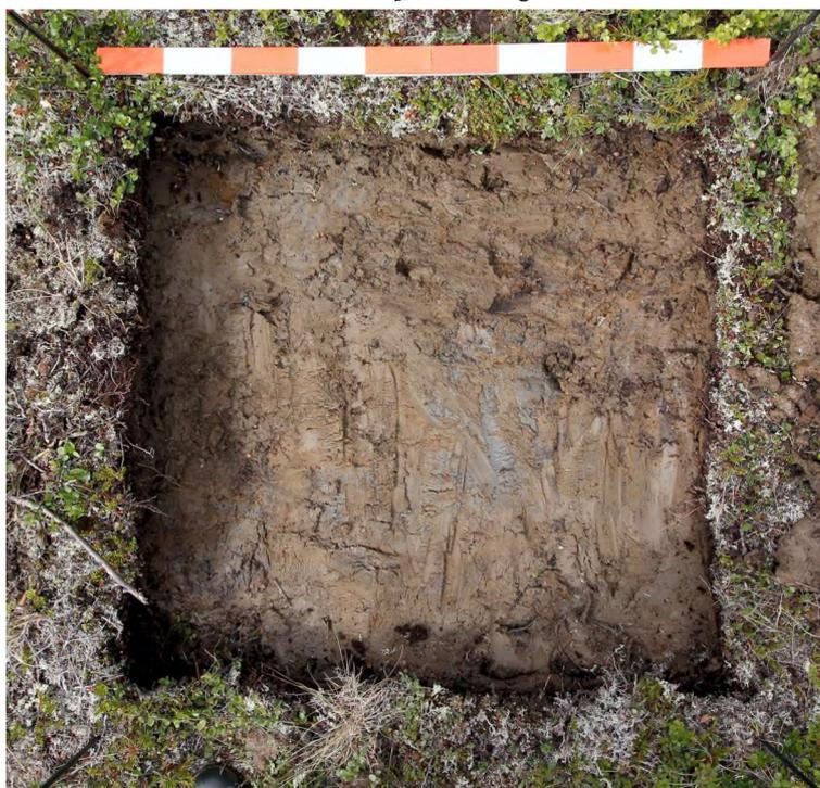
Рис. 19. Межпромысловый нефтепровод «ЦПС-ХТТ» Ардалинского нефтегазового промысла. Площадка подогревателя нефти в районе 42 км нефтепровода. Вид на поверхность раскопанного шурфа № 1 сверху. Вскрыт суглинок – пльвун
