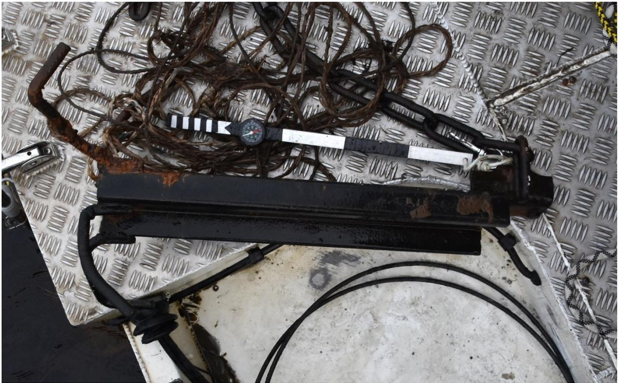
Рисунок 21 - Цель S-1 – якорь кустарного производства на борту катера.
