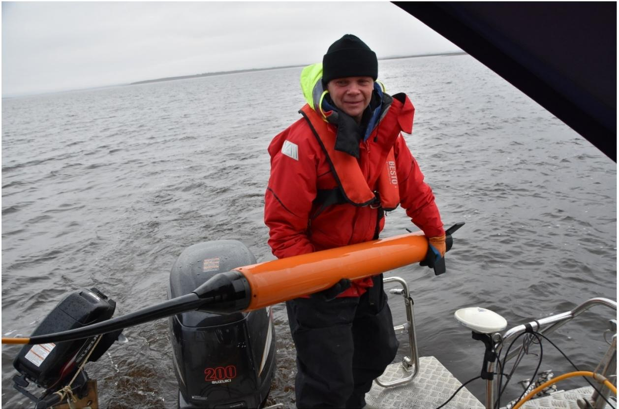
Рисунок 10 – Буксируемое устройство магнитометра SeaSPY.
