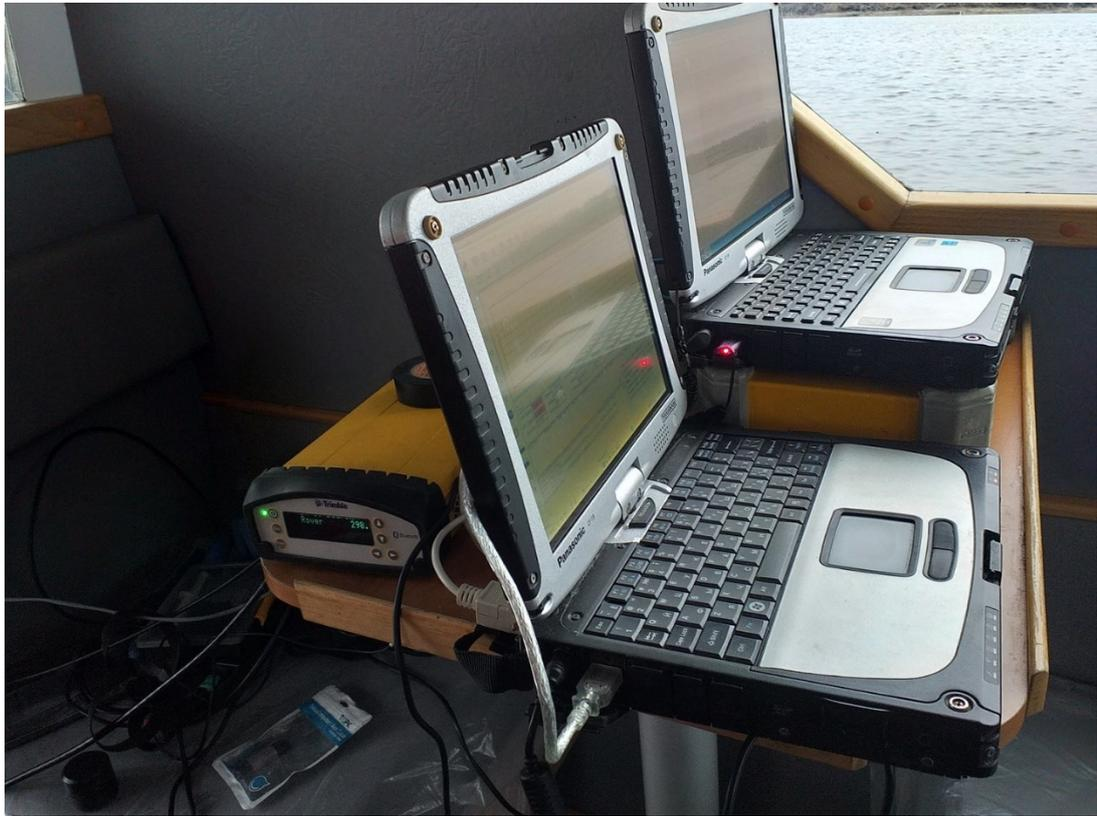
Рисунок 12 – Пост управления и сбора данных гидролокатора бокового обзора и буксируемого магнитометра.
