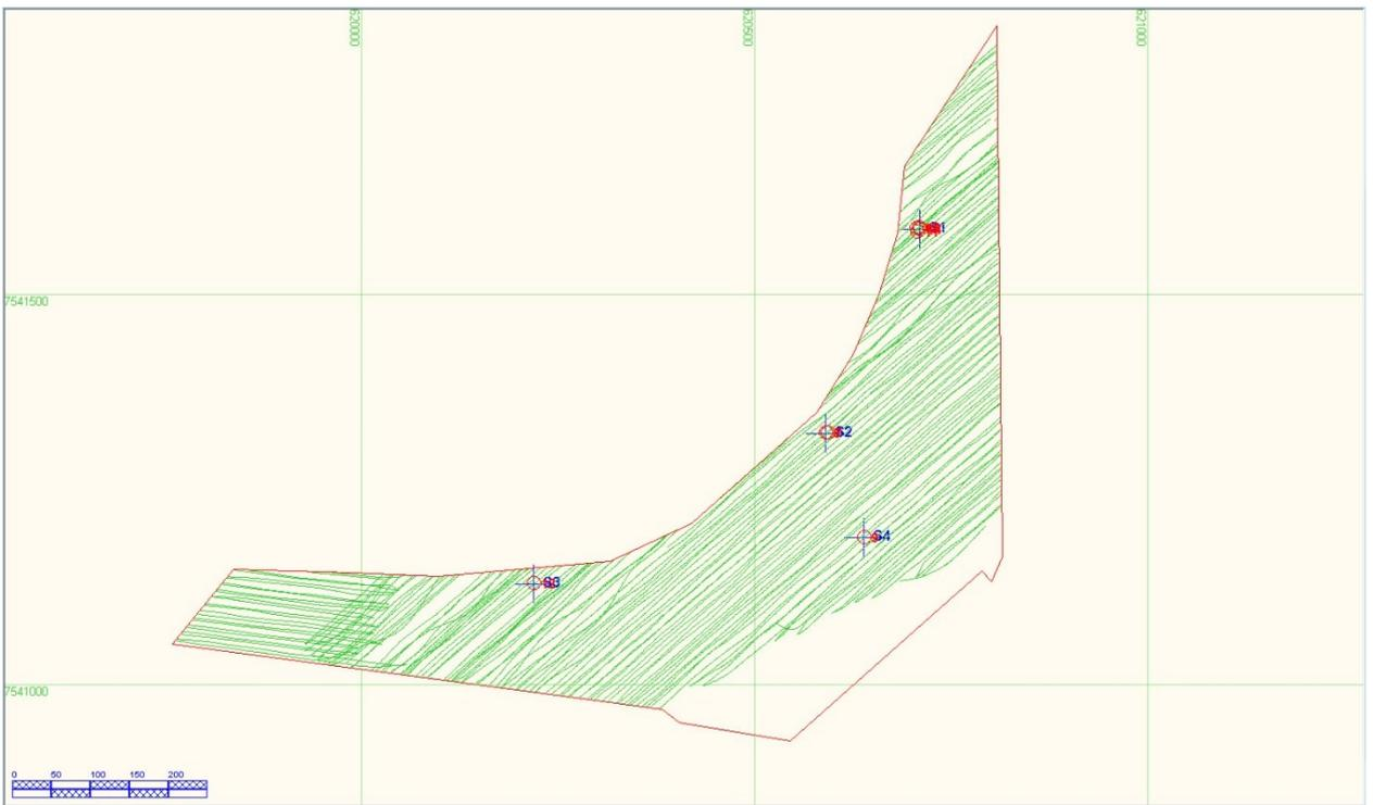
Рисунок 15 – Контур обследованного участка с треками съемочных галсов и местоположением выявленных целей.
